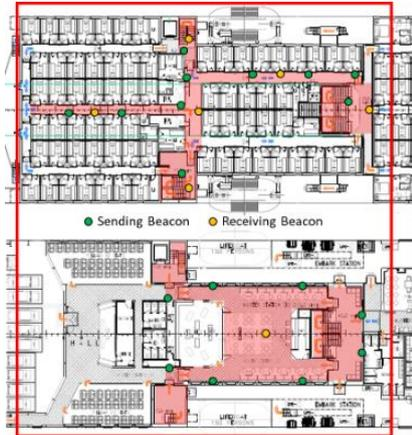
L'area è stata equipaggiata con beacon Bluetooth di ricezione e di trasmissione
