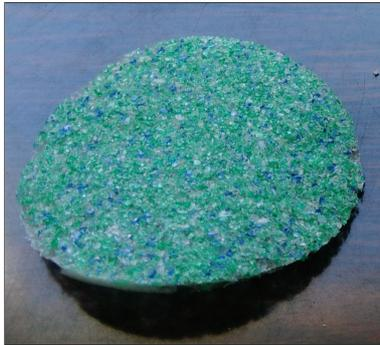
Un biopolimero ricavato dalla lavorazione delle alghe rosse permette di sfruttare materiali plastici o inerti di altro genere per realizzare **una schiuma adatta all'isolamento acustico e termico delle abitazioni, evitandone la dispersione nell'ambiente marino**. L'invenzione del ricercatore Marco Caniato, della Facoltà di Scienze e Tecnologie della Libera Università di Bolzano, rappresenta un importante contributo alla lotta contro le microplastiche.
