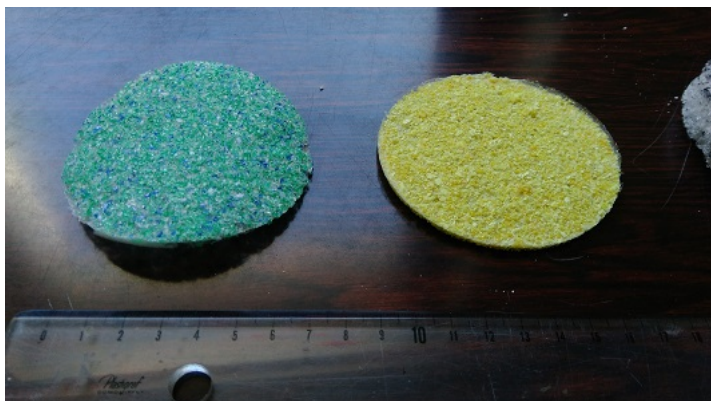
Marco Caniato ha utilizzato un biopolimero che si è dimostrato estremamente efficace come isolante termico e acustico per applicazioni industriali, civili e marine.
