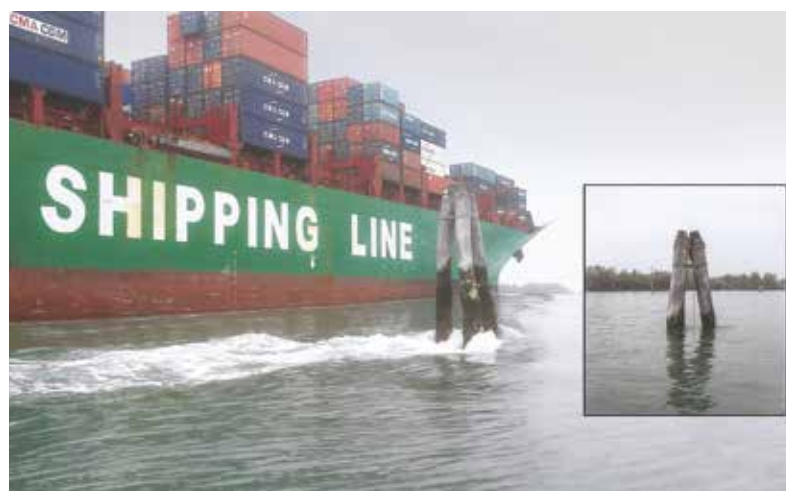
Figura 2. L'onda di depressione generata dal passaggio della nave Xin Qing Dao (velocità 8.1 nodi, lunghezza 279 m, larghezza 40 m, pescaggio 11 m) durante il transito in ingresso al porto del 4/6/2016. Nell'inserito è visualizzato il gruppo di bricole negli istanti immediatamente precedenti il passaggio della nave. L'ampiezza dell'onda di depressione misurata in questo evento supera i 2 metri (immagine degli autori)
