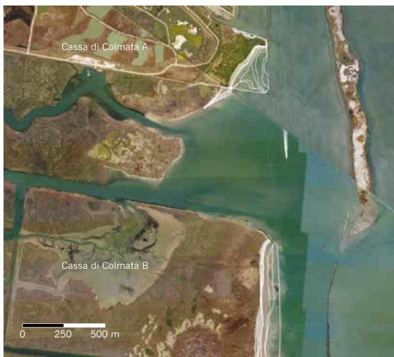
Figura 9. Arretramento complessivo della linea di riva delle casse di colmata A e B. La prima linea riportata per la cassa A è del 1987, mentre per la cassa B è del 1974. L'ultima linea di riva rappresentata è invece per entrambe le casse è relativa alla situazione del 2018
