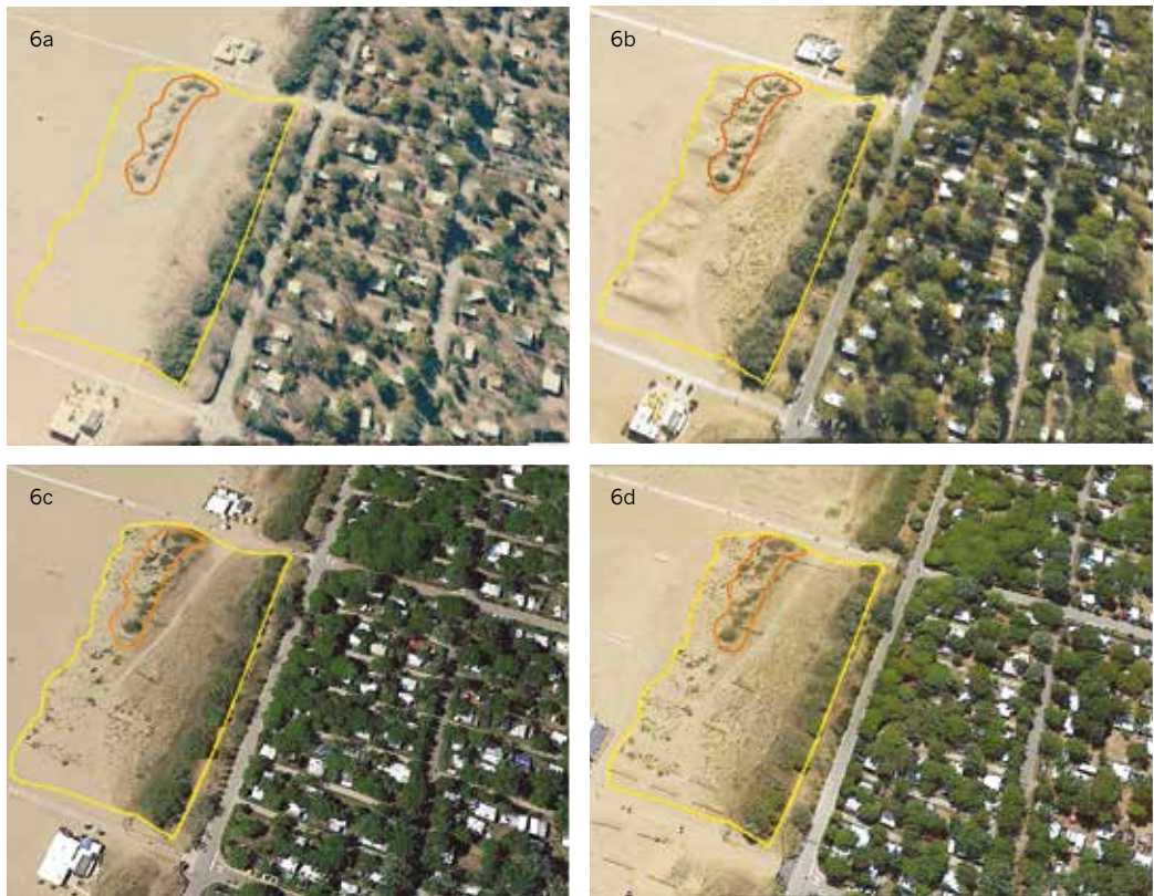
A destra Figura 6. Esempio di ricostituzione della fascia dunale nell'ambito di Cavallino - Punta Sabbioni, Camping Marina di Venezia. Complesso dunale presente prima dell'intervento (in arancione) nel 2010 (6a) e dopo gli interventi di posa di frangivento (in giallo) nel 2014 (6b), nel 2016 (6c) e nel 2018 (6d), (elaborazione Consorzio Venezia Nuova - Agriteco)
