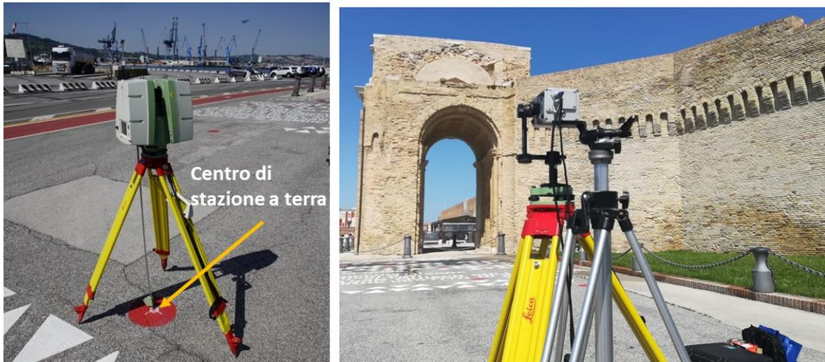
Figura 1. Setup sperimentale per la modalità di ripresa singola
