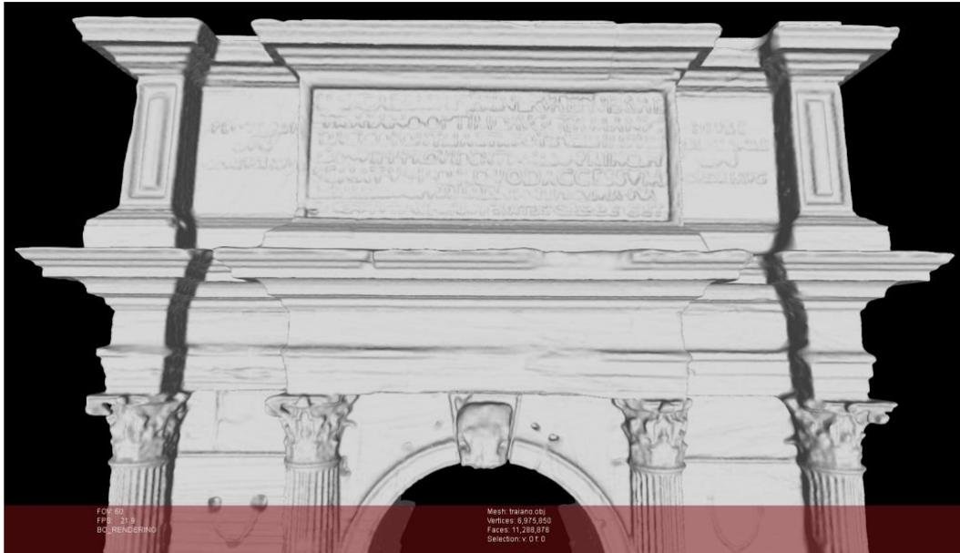
**FIGURA 13 VISTA PROSPETTICA DI DETTAGLIO DEL MODELLO 3D MESH OTTENUTO DELL'INTEGRAZIONE DELLA NUVOLA DI PUNTI DA LASER CON LA NUVOLA DI PUNTI DA FOTOGRAMMETRIA PER LE PARTI MANCANTI.**
