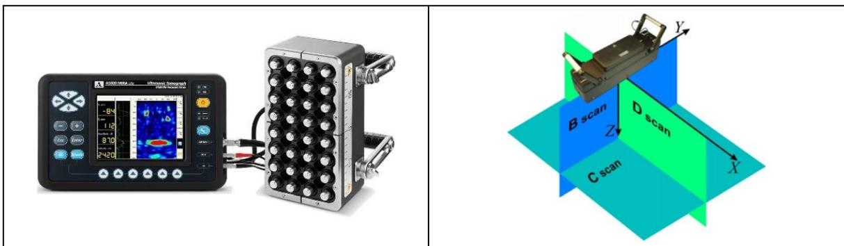
Figura 7. A sinistra l'A1020 MIRA-Lite, a destra la rappresentazione delle scansioni B, C e D
