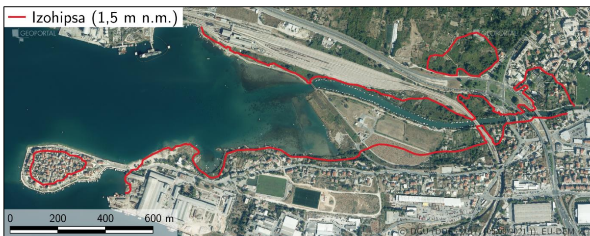
Slika 66. Ušće rijeke Jadro s visinskom linijom 1,5 m nadmorske visine (geodetsko snimanje obavio Frane Gilić, 2021)
