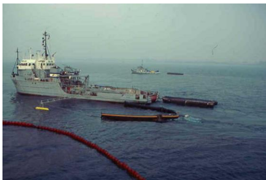
Figura 8: Panne skimmer con dispositivo di skimming incorporato dispiegato da una singola imbarcazione
