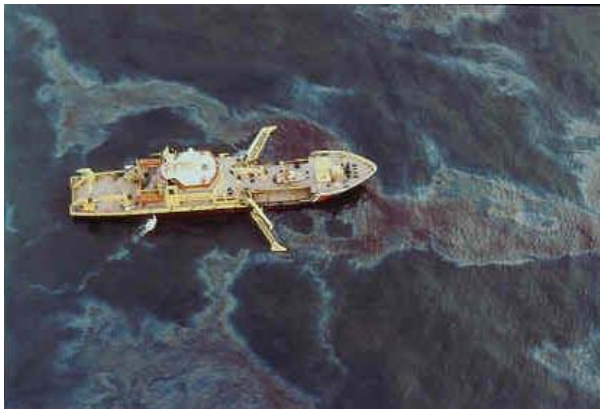
Figura 9: Una nave per il recupero di idrocarburi con sweeping arms attaccati a ciascuno dei due lati
