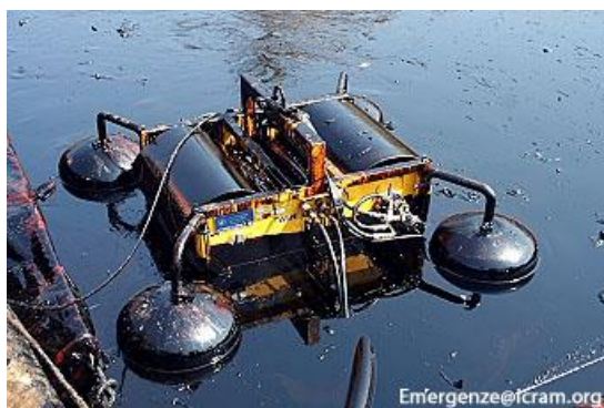
Figura 4: Principio di funzionamento ed esempio di skimmer a tamburo oleofilo
