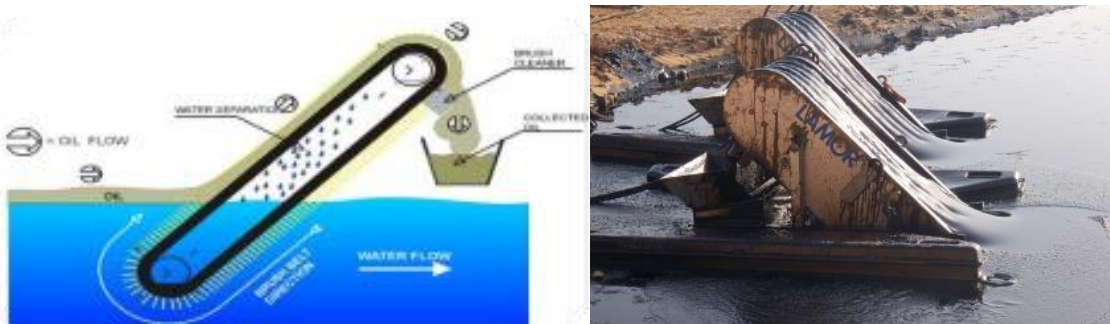
Figura 6: Principio di funzionamento ed esempio di skimmer oleofilo a spazzole
