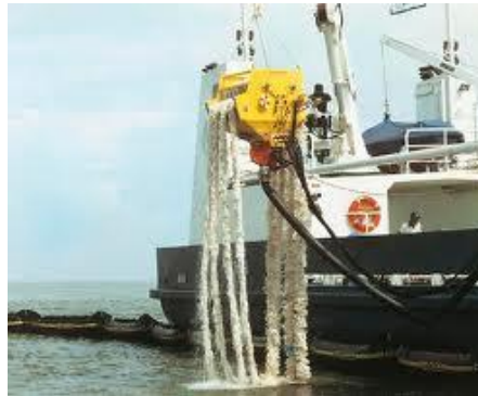
Figura 7: Principio di funzionamento ed esempio di skimmer a fune oleofila
