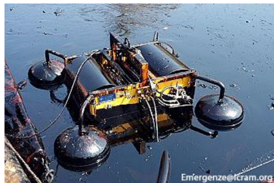
Slika 4: Princip rada i primjerak skimera s oleofilnim bubnjem
