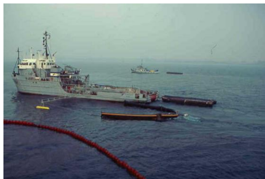
Slika 8: Brana za skidanje ulja s ugrađenim uređajem sa rekuperaciju, postavljena s jednog plovila
