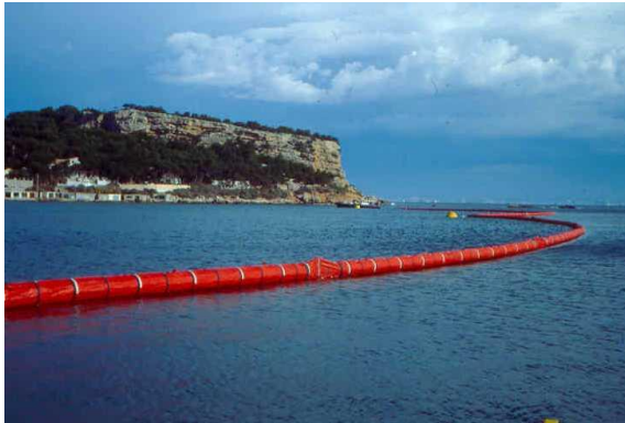
Slika 4: Usidrena, zrakom punjena, brana sa zavjesom
