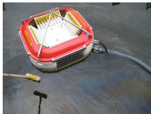
Slika 5: Princip rada i primjerak skimera s oleofilnim diskovima (disk skimera)
