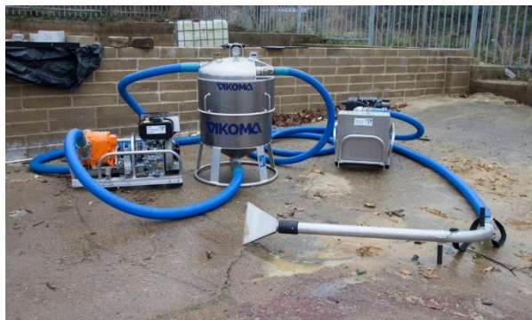
Slika 1: Princip rada i primjerak skimera s izravnim usisom/usisnog skimera
