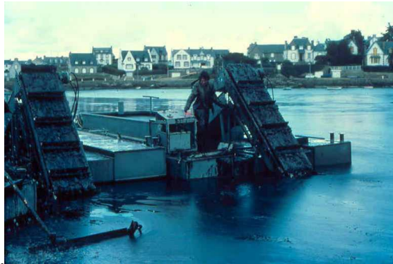
Slika 3: Princip rada i primjerak skimera s prijenosnom trakom
