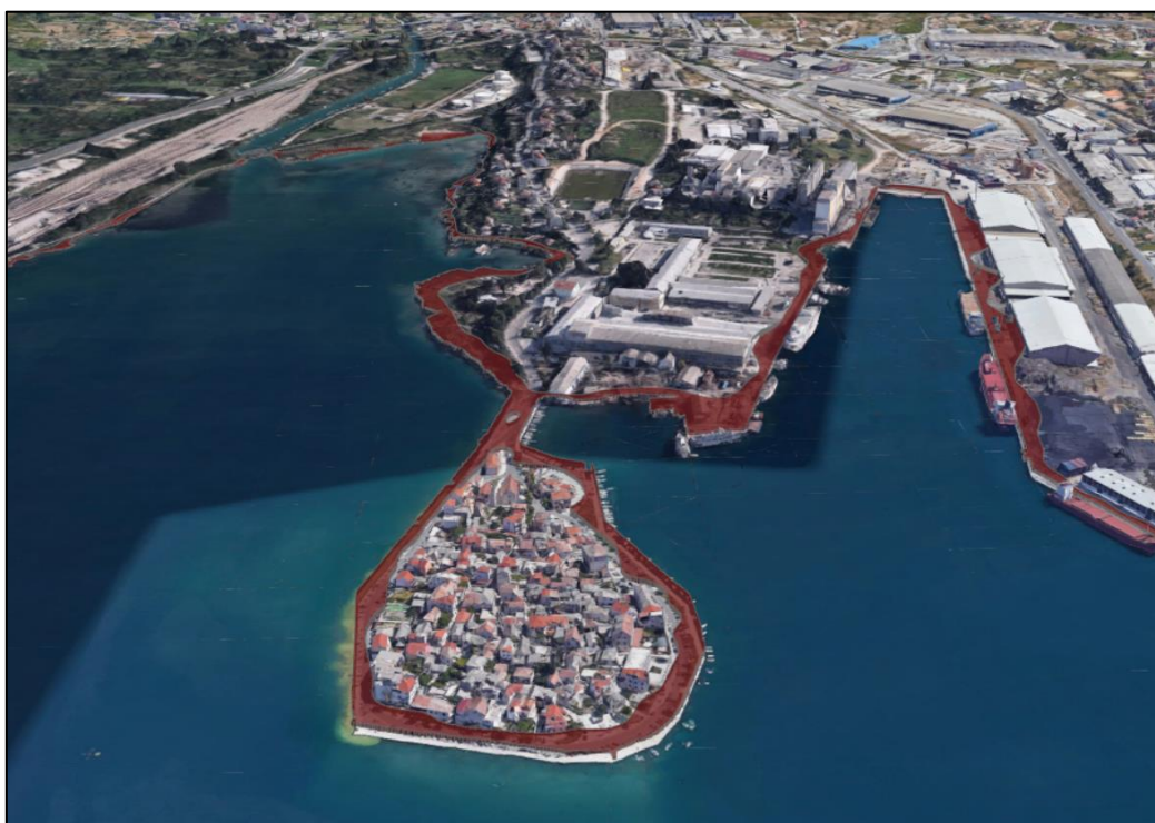
Slika I-7. Dijelovi obalnog prostora na prostoru Vranjica zahvaćeni izdizanjem morske razine za 1 m
