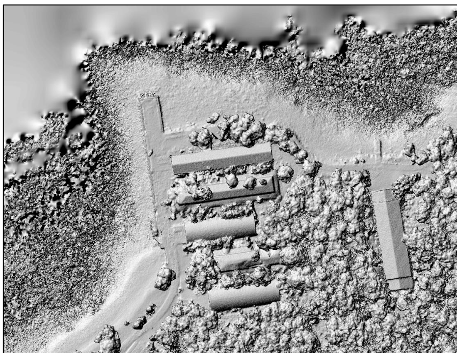
Slika II-21. Artefakti u izrađenom modelu na vodenim površinama
