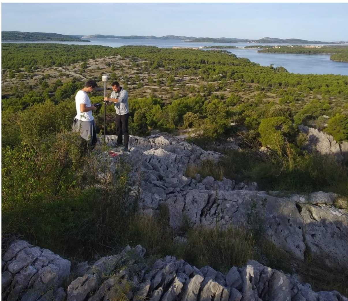
Slika IV-10. Prikupljanje orijentacijske točke u blizini Vidikovca
