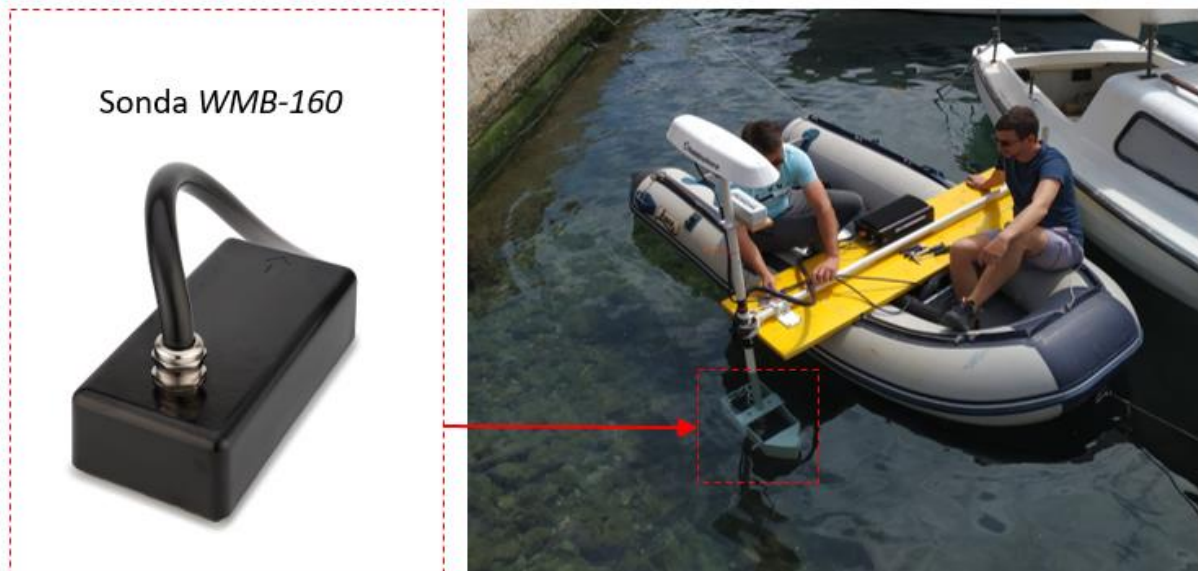
Slika I-13. Sonda WMB-160 (URL7) i njezina pozicija u integralnom mjernom sustavu
