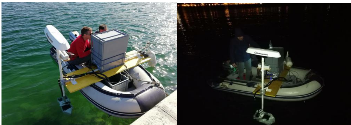
Slika I-5. Gumenjak Luna na kojem je instaliran integralni mjerni sustav
