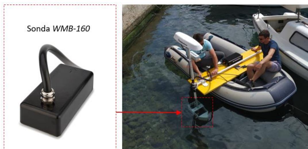
Slika I-13. Sonda WMB-160 (URL9) i njezina pozicija u integralnom mjernom sustavu
