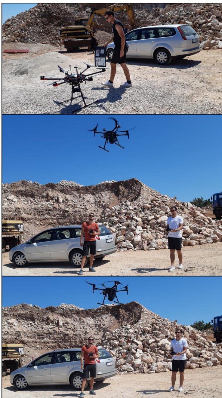
Slika IV-26. Let Matrice 600 Pro s integriranom multispektralnom kamerom prema zadanoj misiji. (na slikama: I. Marić i F. Domazetović – stajalište Kamenolom)
