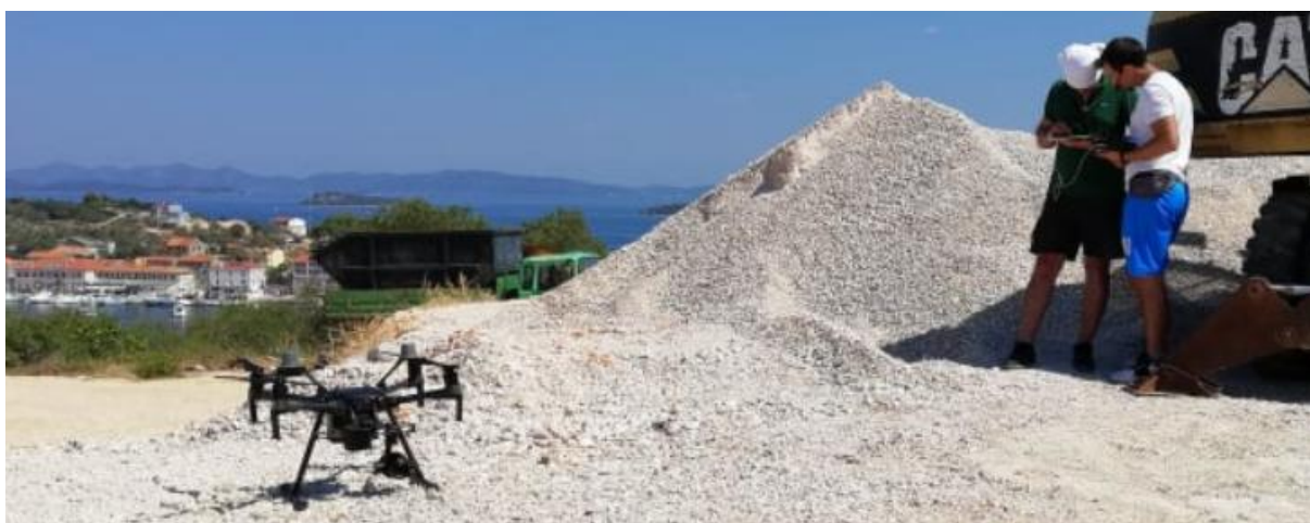
Slika II-17. Izvođenje snimanja za potrebe generiranja DOF-a (5 cm)
