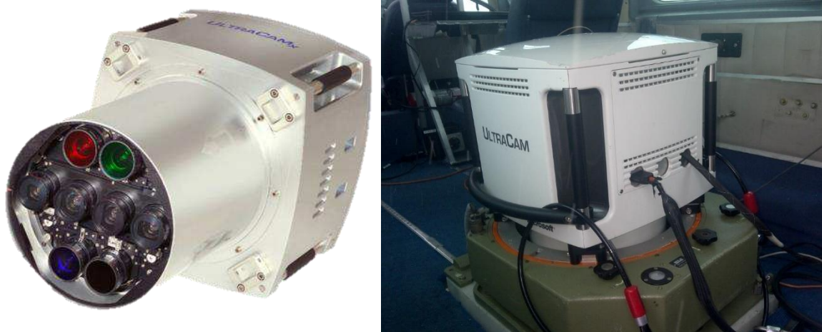
Slika II-2. Izgled i raspored senzora UltraCam X digitalne kamere (lijevo); UltraCam X kamera postavljena unutar zrakoplova (desno)
