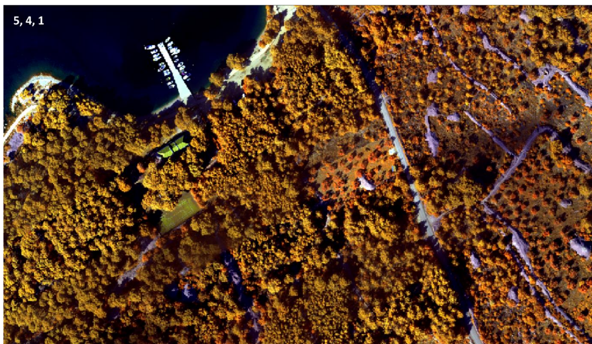
Slika IV-31. Kombinacija kanala 5, 4, 1 na kojoj se mogu uočiti razlike u zemljišnom pokrovu
