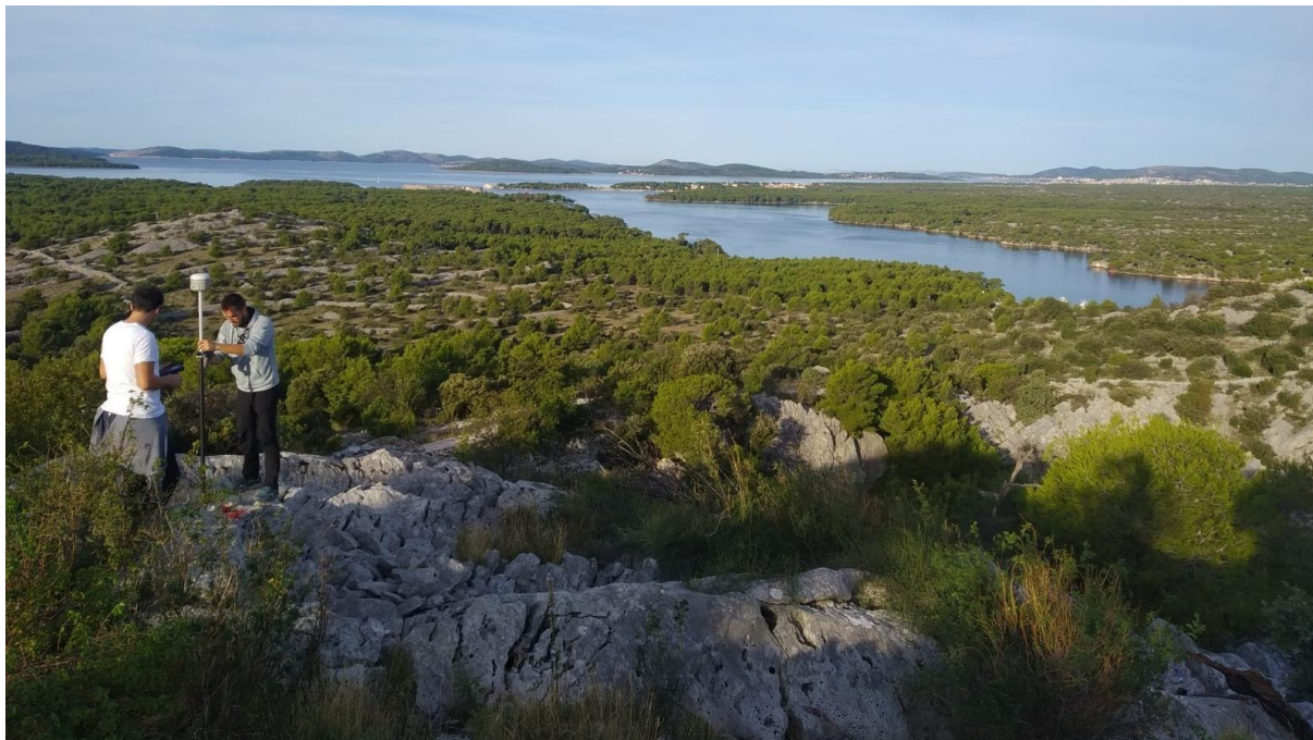
Slika II-9. Prikupljanje orijentacijske točke na terenu pomoću Stonex S10 GNSS
