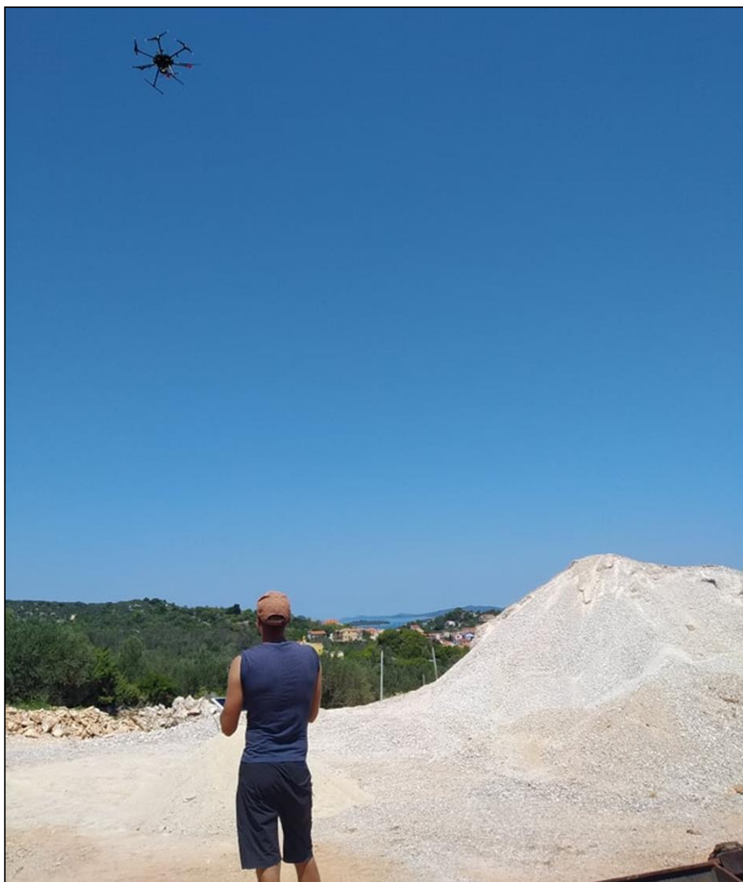
Slika IV-25. Let Matrice 600 Pro s integriranom multispektralnom kamerom prema zadanoj misiji. (na slikama: F. Domazetović – stajalište Kamenolom)
