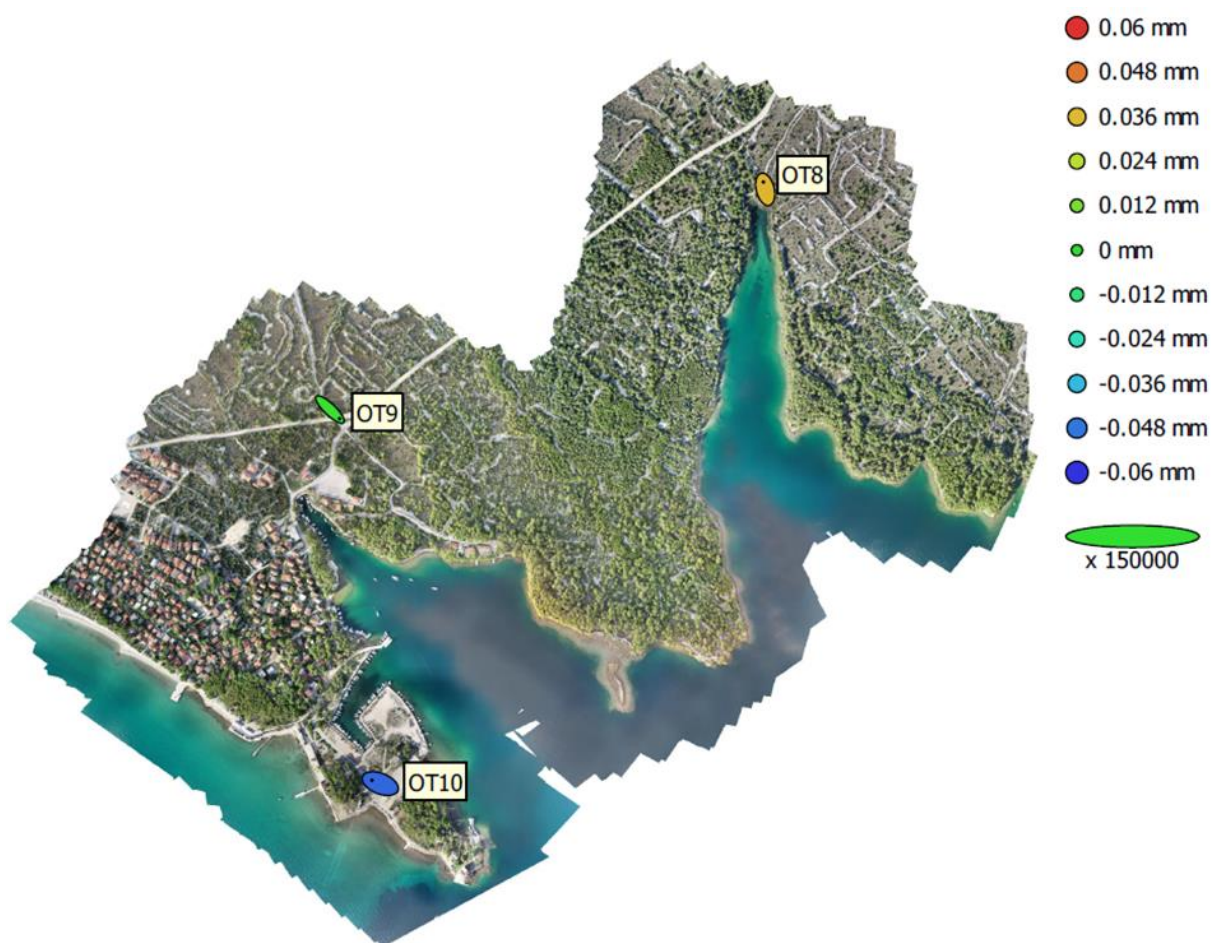
Slika II-12. Lokacije i pogreške orijentacijskih točaka unutar chunka 2
