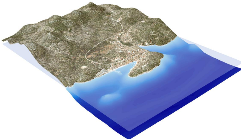
Slika II-22. Perspektivni blokovski prikaz integralnog modela uvala Sali i Sašica (kombinacija DOF-a i digitalnog modela visina)
