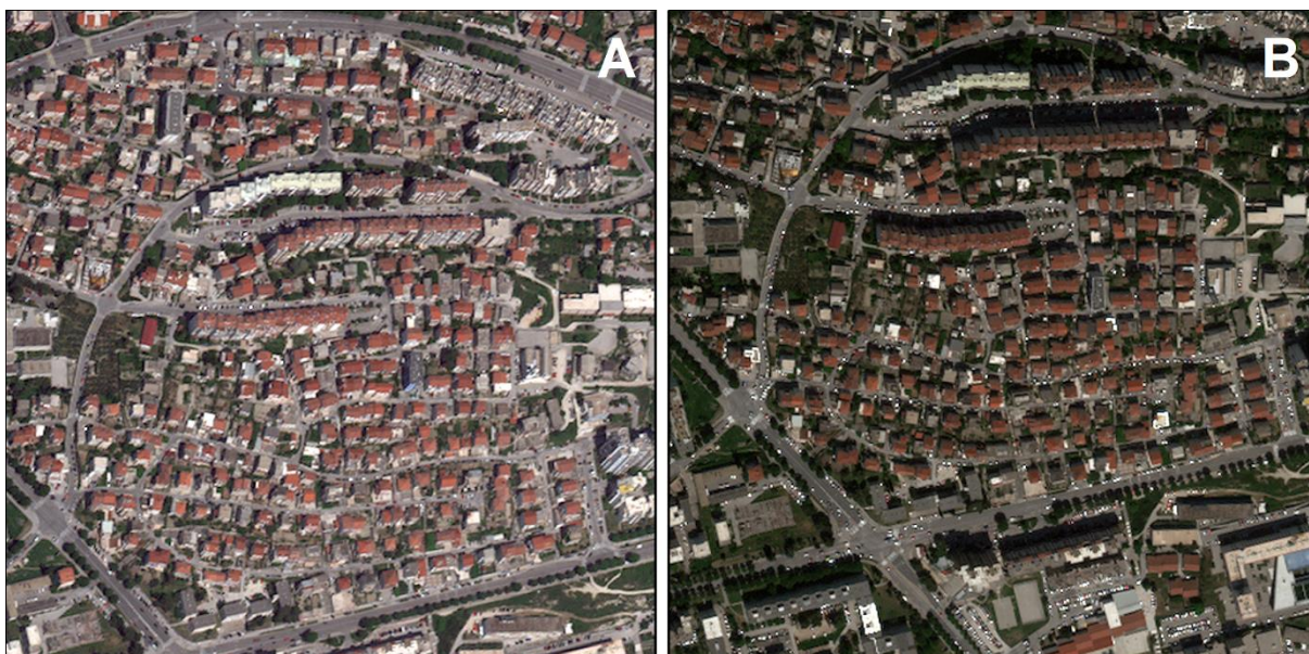
Slika III-2. Multispektralni snimak prije (A) i poslije (B) ortorektifikacije
