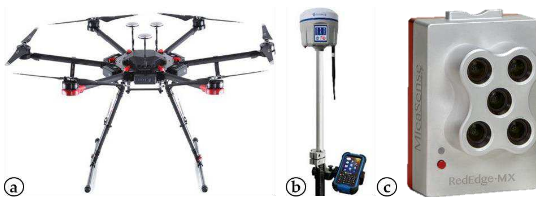
Slika IV-24. a) DJI Matrice 600 Pro , b) Stonex S10 i c) Red-Edge Mica SenseMX
