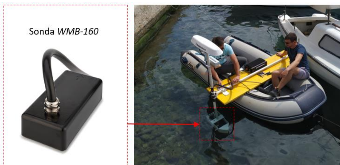
Slika I-13. Sonda WMB-160 (URL9) i njezina pozicija u integralnom mjernom sustavu
