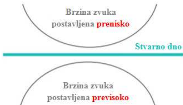
Slika I-17. Netočnosti prikaza morskog dna zbog pogrešne brzine zvuka
