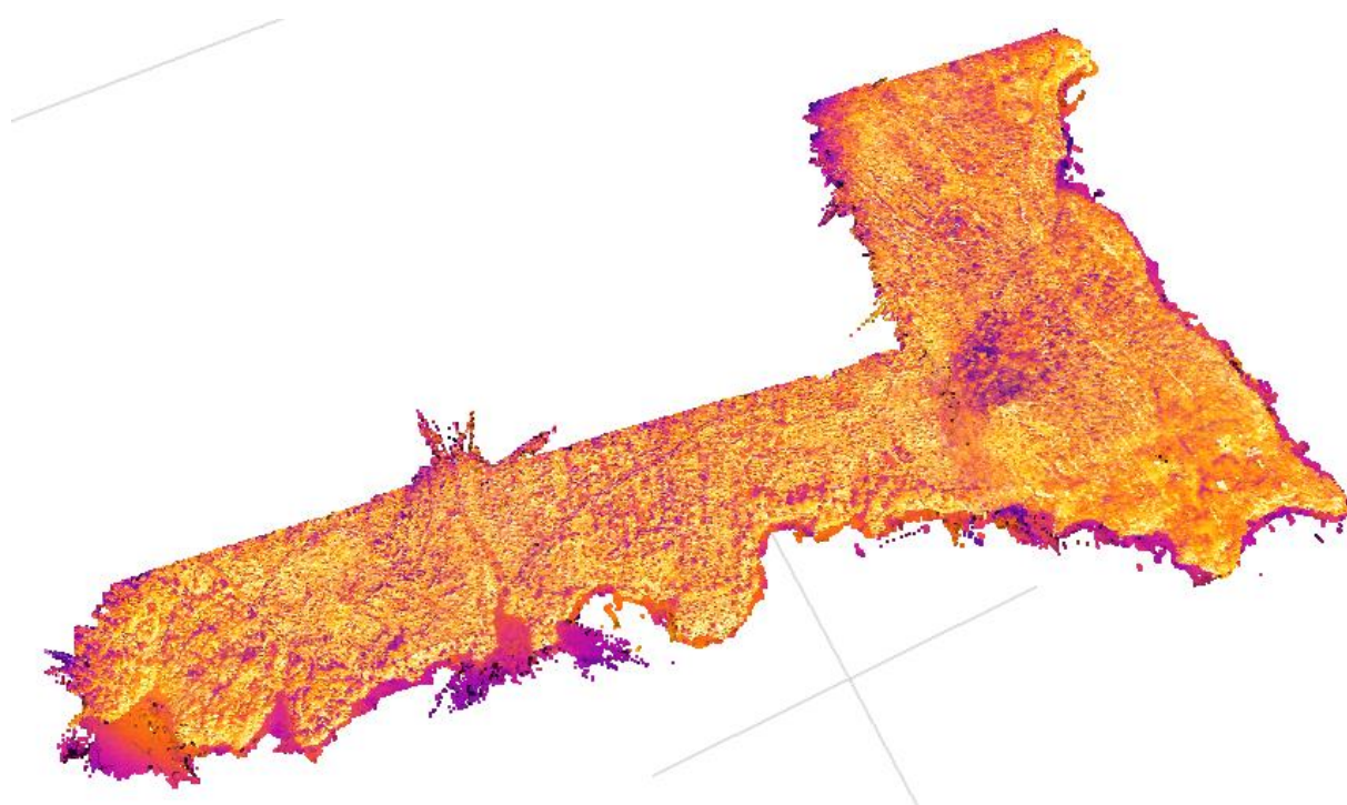
Slika III-11. Izvedeni gusti oblak točaka u drugom snimanju (primjer desne obala)
