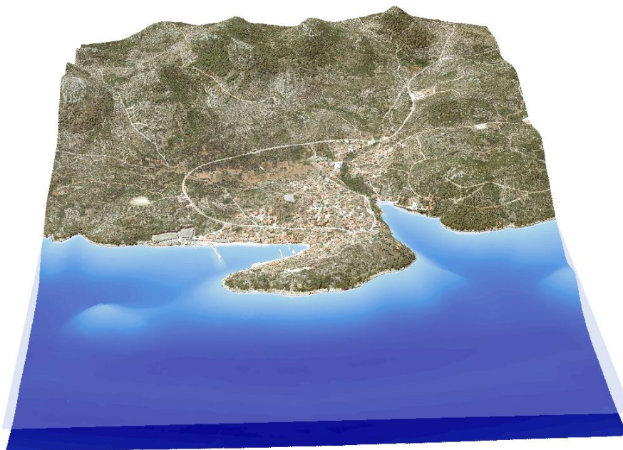
Slika II-23. Perspektivni blokovski prikaz integralnog modela uvala Sali i Sašica (kombinacija DOF-a i digitalnog modela visina)
