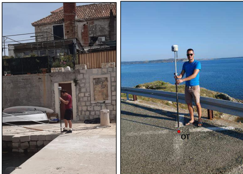
Slika II-6. Terensko prikupljanje OT i KT sa Stonex S10 RTK GPS-om
