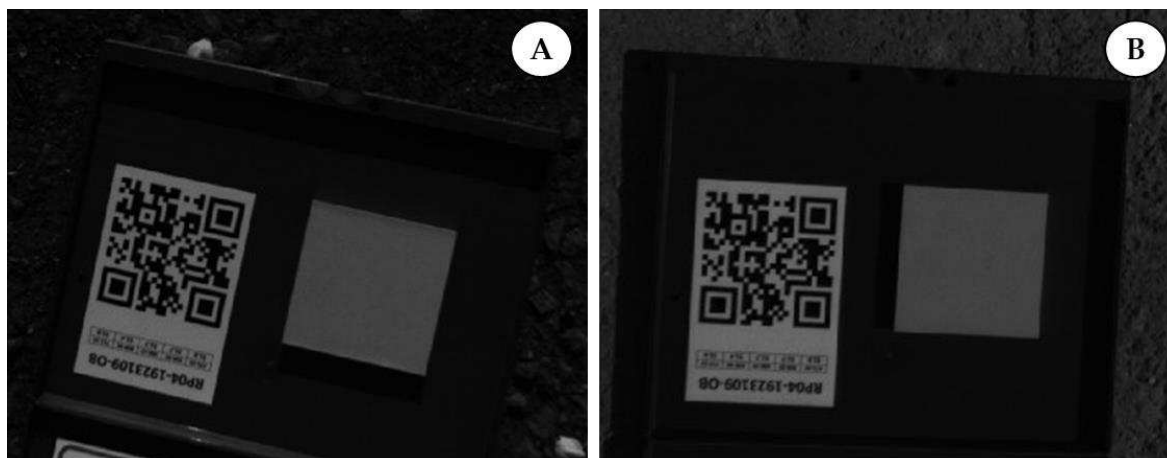
Slika IV-33. Slike refleksijskog kalibracijskog panela A) prije i B) nakon izvođenja misije
