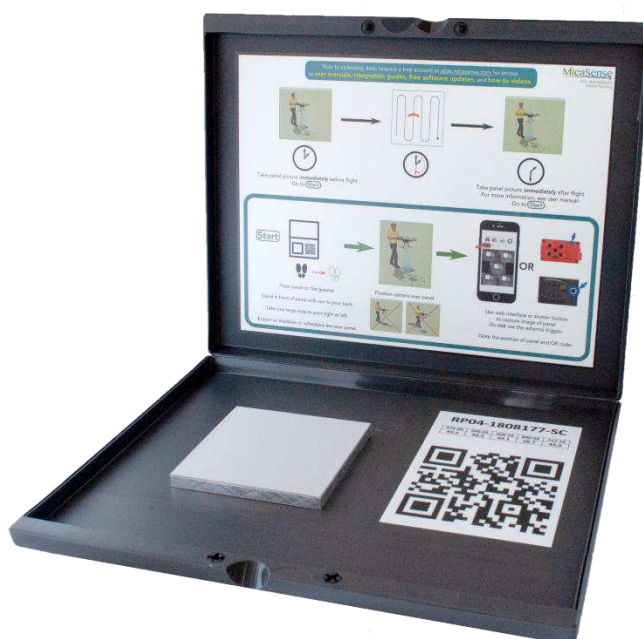
Slika IV-32. Izgled refleksijskog kalibracijskog panela te upute za kalibraciju
