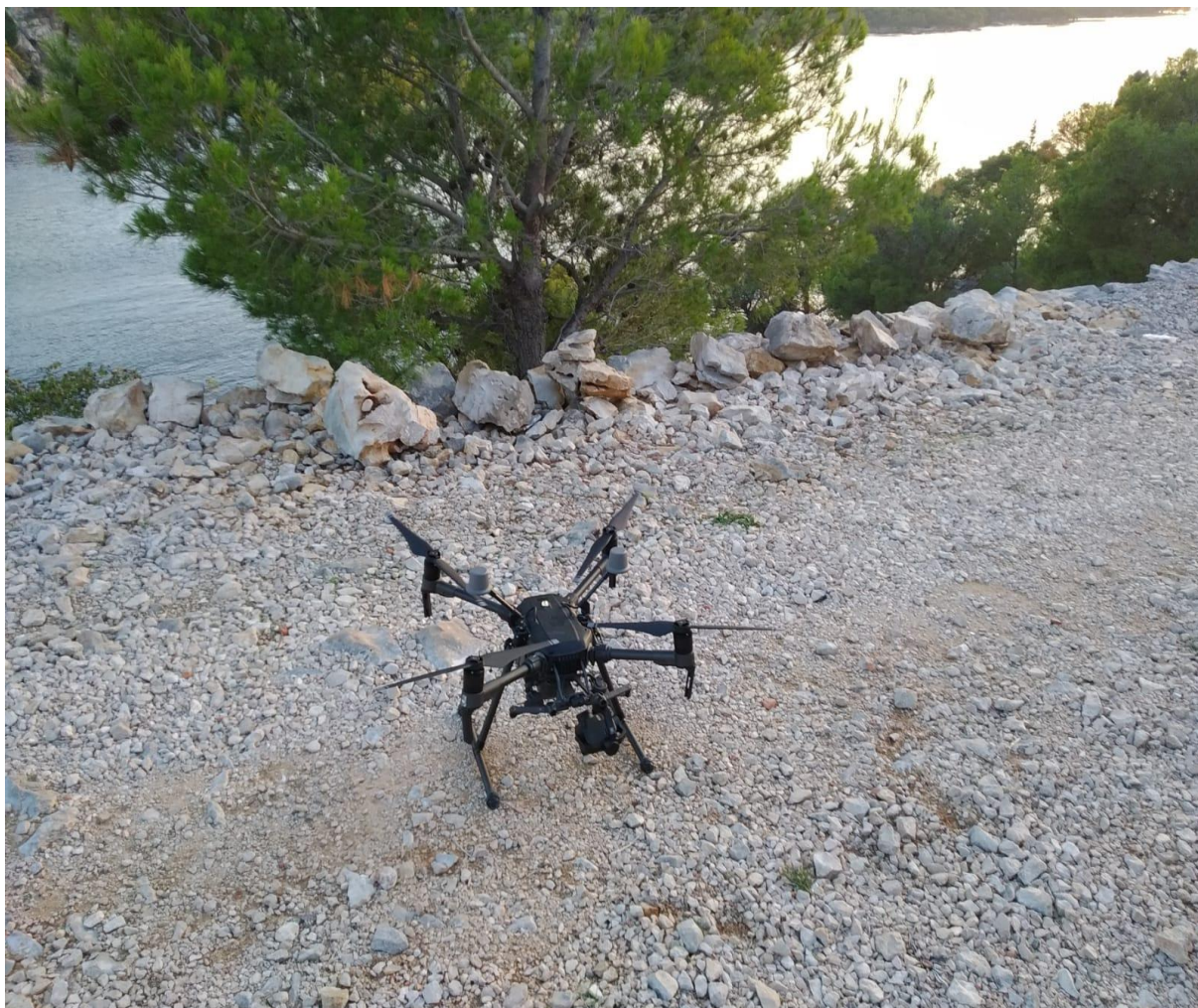
Slika II-4. Izvođenje aerofotogrametrijskog snimanja (4) – priprema Matrice 210 RTK
