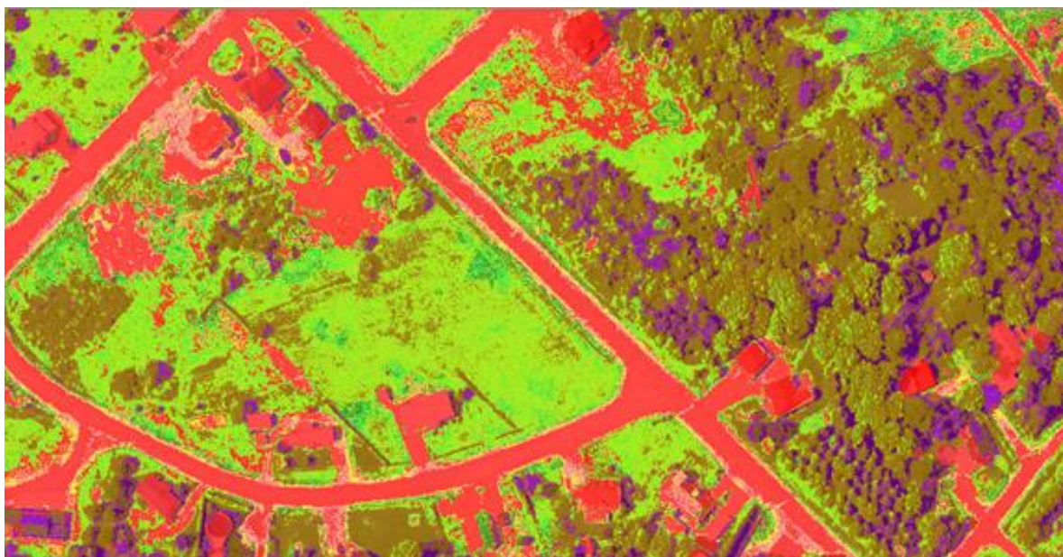
Slika IV-52. Efekt "soli i papra" koji se javlja u pixel-based procesu klasifikacije na visoko-rezolucijskim slikama
