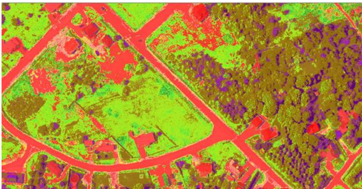
Slika IV-27. Efekt "soli i papra" koji se javlja u pixel-based procesu klasifikacije na visoko-rezolucijskim slikama
