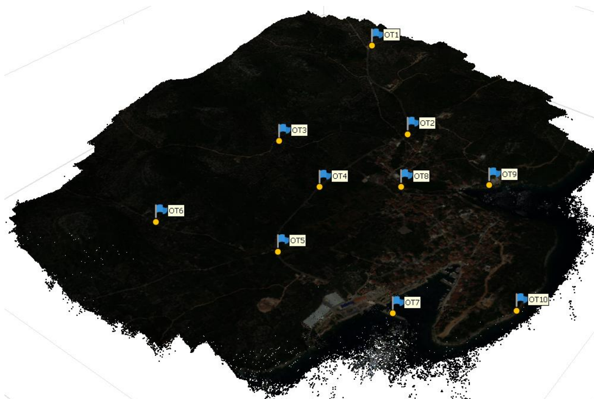
Slika IV-41. Prikaz svih dodanih orijentacijskih točaka na orijentiranom modelu
