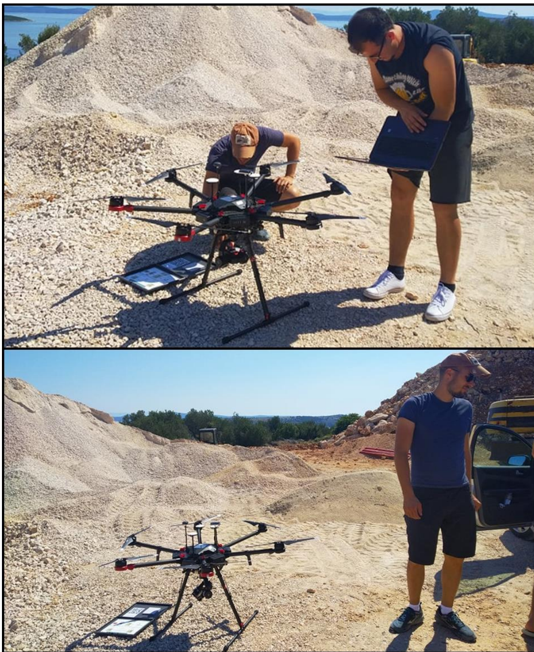
Slika IV-34. Kalibracija multispektralne kamere Mica Sense Red Edge na terenu
