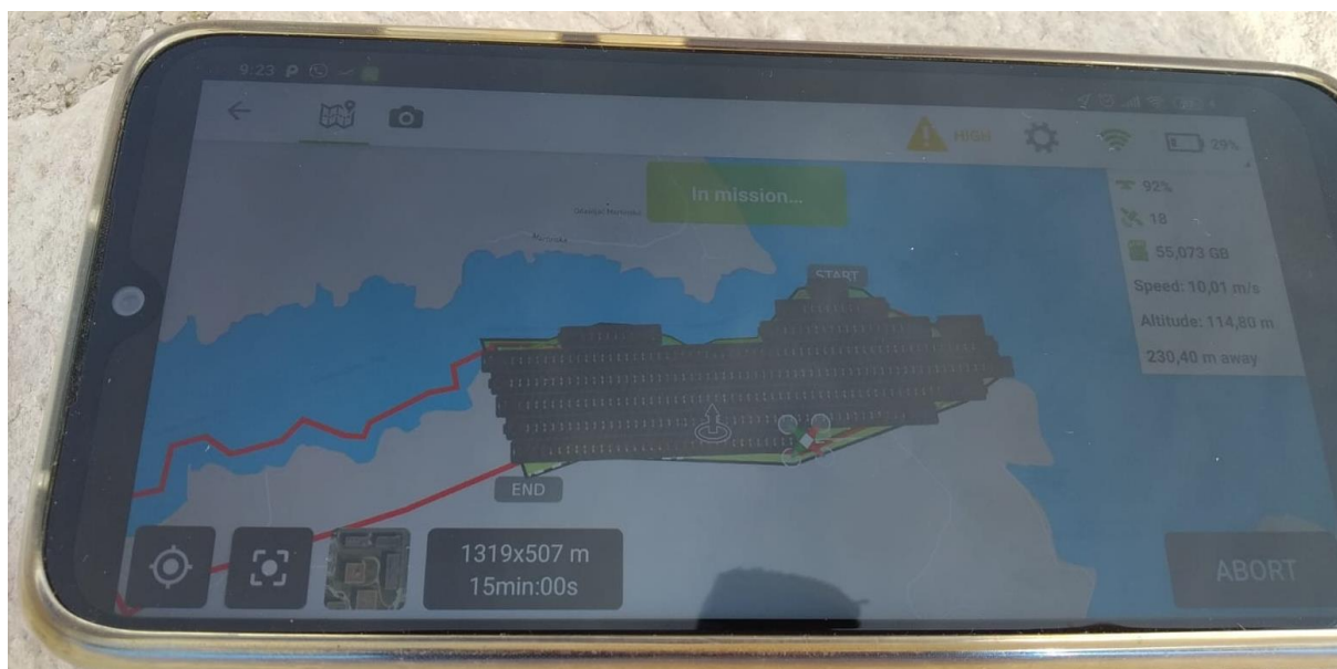
Slika II-5. Primjer misije isplanirane u Pix4Dcapture misiji
