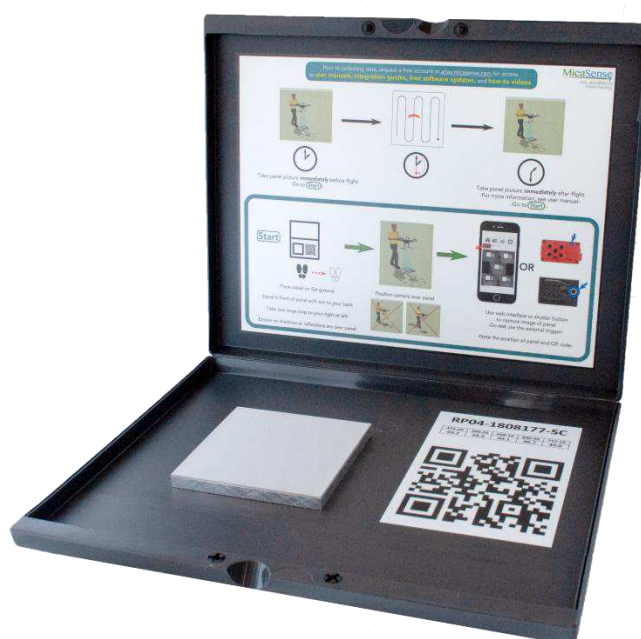
Slika IV-9. Izgled refleksijskog kalibracijskog panela te upute za kalibraciju
