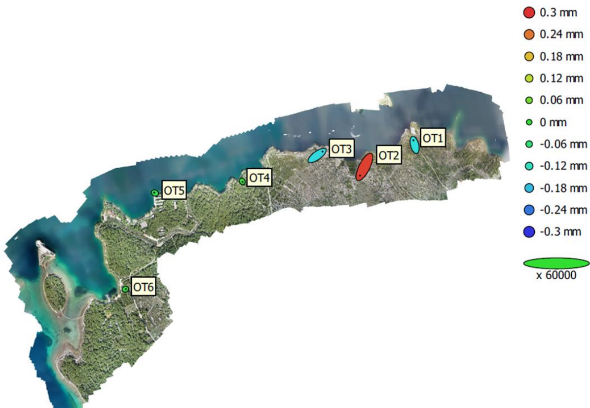
Slika II-11. Lokacije i pogreške orijentacijskih točaka unutar chunka 1 .
