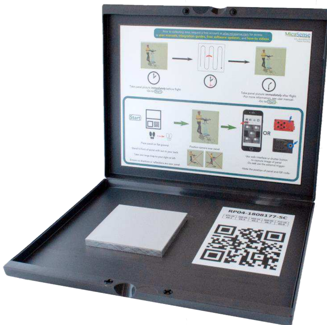
Slika IV-14. Izgled refleksijskog kalibracijskog panela te upute za kalibraciju
