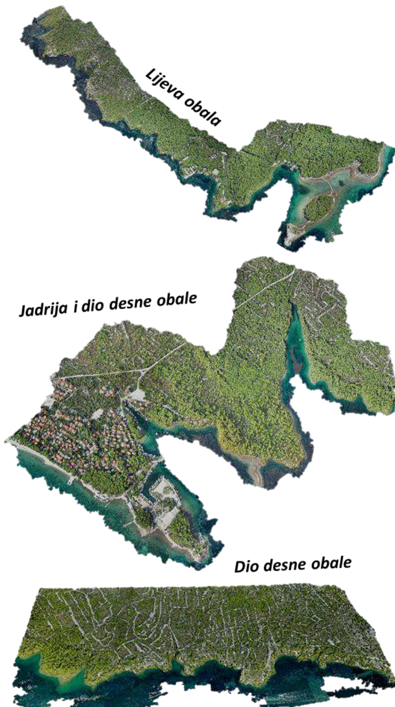
Slika II-13. Isječci gustog oblaka točaka unutar kanala Sv. Ante
