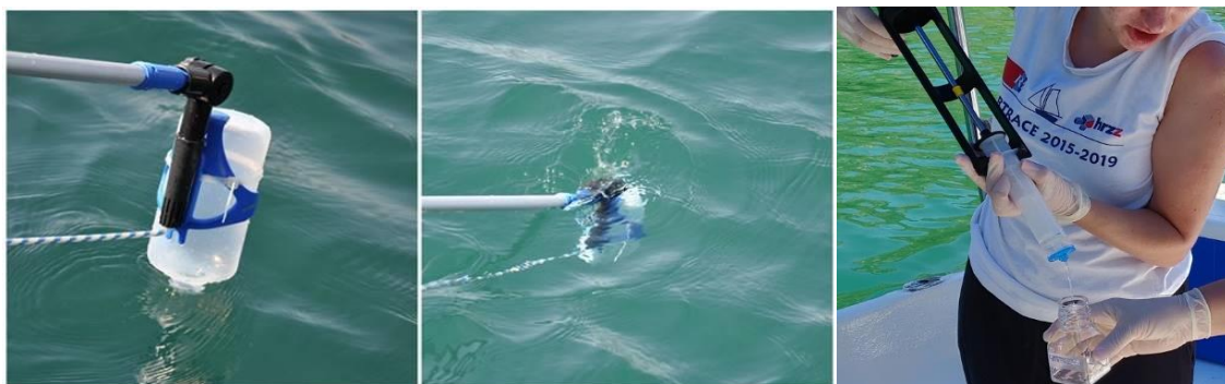
Slika III-11. Tehnika uzimanja pojedinačnog uzorka površinskog mora korištenjem teleskopskog štapa.
