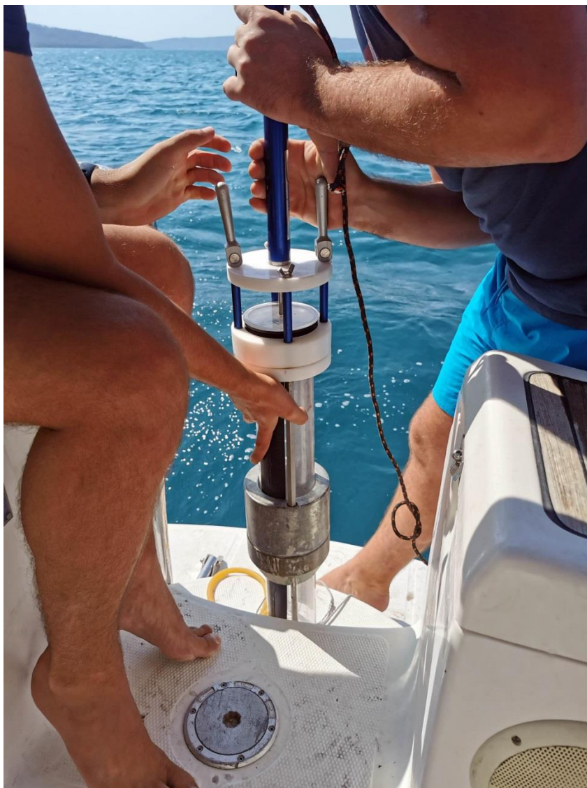
Slika I-1. Gravitacijski korer spreman za uzorkovanje
