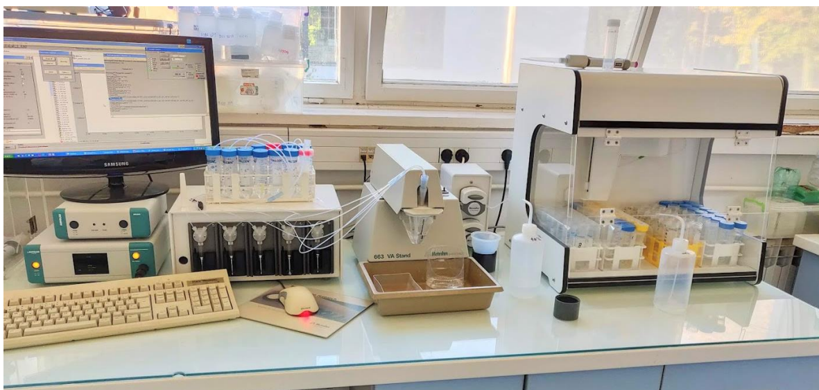
Slika III-12. Automatizirani voltametrijski sustav za određivanje koncentracija Zn, Cd, Pb, Cu, Ni i Co.
