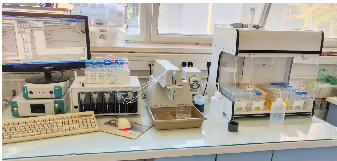
Slika III-10. Automatizirani voltametrijski sustav za određivanje koncentracija Zn, Cd, Pb, Cu, Ni i Co.
