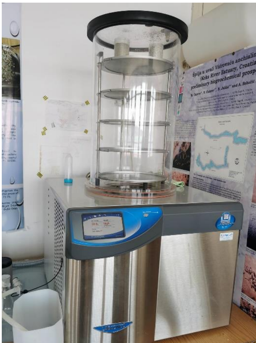
Slika II-2 Liofilizator na morskoj postaji Instituta Ruđer Bošković.
