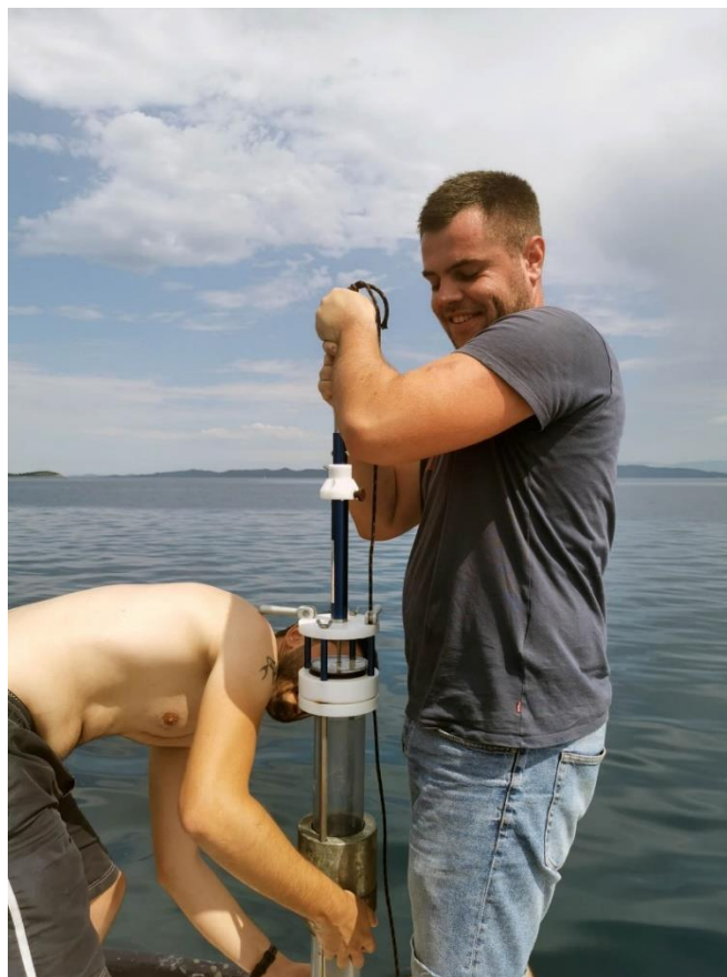
Slika I-7. Uzorkovanje sedimenta gravitacijskim korerom UWITEC s cijevima od pleksiglasa promjera 90 mm (lipanj 2020)
