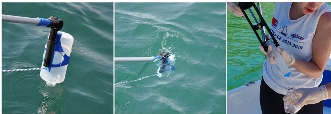
Slika VII-9. Tehnika uzimanja pojedinačnog uzorka površinskog mora korištenjem teleskopskog štapa.
