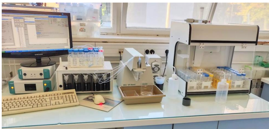
Slika VII-10. Automatizirani voltametrijski sustav za određivanje koncentracija Zn, Cd, Pb, Cu, Ni i Co.
