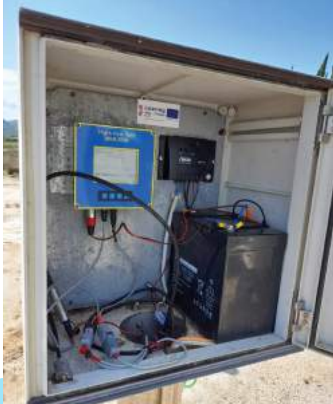
SLIKA 10. UNUTRAŠNOST MJERNE KUTIJE NA PIJEZOMETRU
