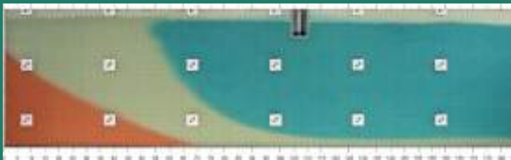
SLIKA 15. PRIKAZ REZULTATA LABORATORIJSKOG MODELA AKTIVNE INTRUZIJE MORSKE VODE UZ PRIMJENU KANALA ZA NAVODNJAVANJE
