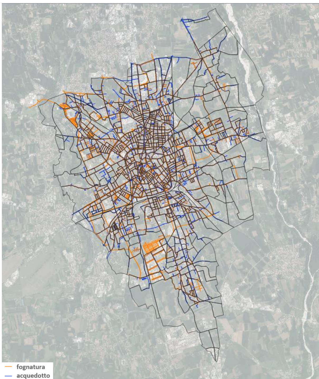
Figura 22 Rete fognatura e acquedotti – Fonte: dati comunali
