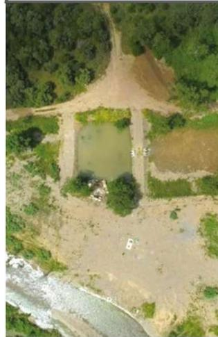
E' il processo mediante il quale l'acqua superficiale viene fatta infiltrare nel sottosuolo al fine di aumentare il volume d'acqua immagazzinata negli acquiferi.
