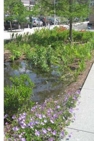
Piccoli giardini, tipicamente utilizzati nelle proprietà private e vicino ad edifici e strade, utilizzati per lo stoccaggio e l'infiltrazione delle acque.
