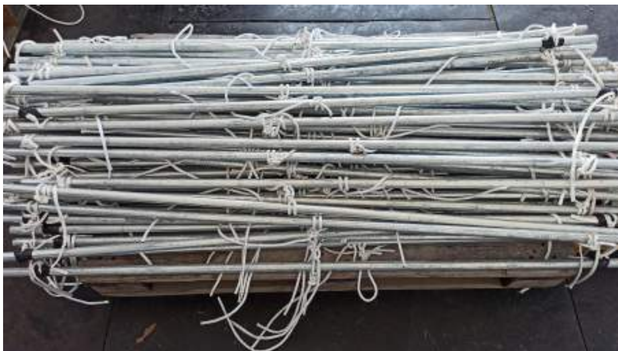
Foto 10: tubi distanziatori in acciaio zincato diametro 1/2" lunghezza 1,5 m
