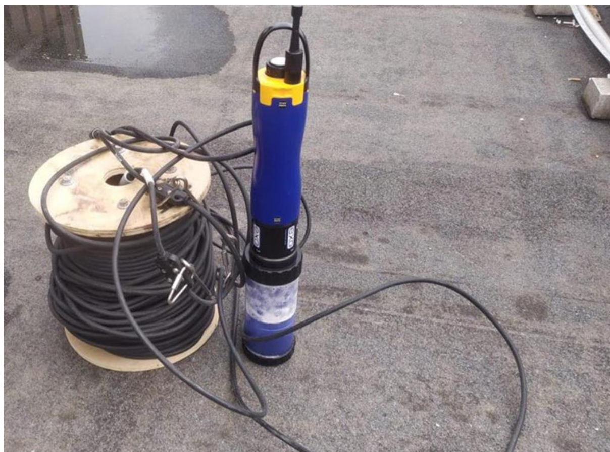
Figure 22 EXO Multiparameter Sonde
