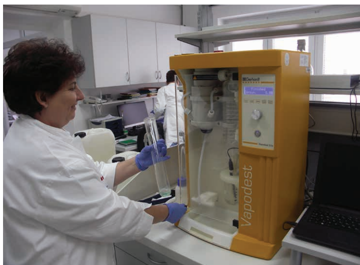
Destilacija i titracija pri određivanju udjela bjelančevina po Kjeldahl-u
