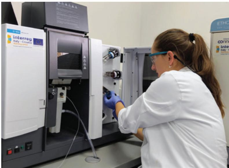
**Spettrofotometro ad adsorbimento atomico (AAS) per la determinazione dei minerali**
