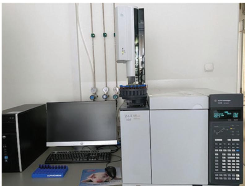
**Gasromatografia con rilevamento a ionizzazione di fiamma (GC-FID) per l'analisi degli acidi grassi**
