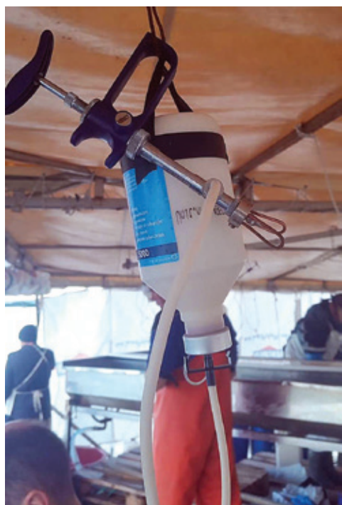
Figura 43. Dispositivo di iniezione calibrato
