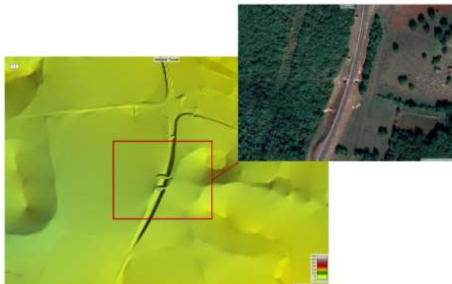
Slika 3.2.5 Primjer lokalne korekcije DMT-a zbog identificiranih propusta
