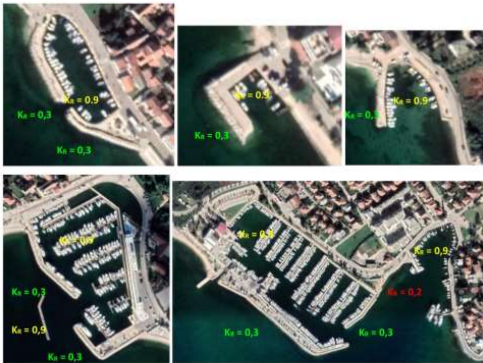
Slika 4.1.13. Refleksijsko-transmisijska svojstva uzduž obalne crte predmetnog akvatorija
