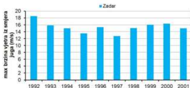
Slika 4.1.4. Maksimalne godišnje brzine vjetra iz modela Aladin – HR za sektor "juga" ( 101.25^{\circ} - 191.25^{\circ} ) i poziciju grada Zadra tijekom razdoblja 1992.-2001.
