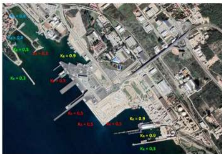
Slika 4.1.14. Refleksijsko-transmisijska svojstva uzduž obalne crte predmetnog akvatorija
