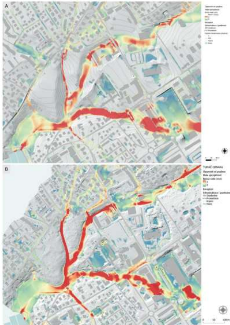
Slika 5.2.7 Usporedba rezultata brzine vode za malu vjerojatnost na dijelu sliva Vruljice: a) mezo razina (rezolucija 1 m), b) mikro razina (rezolucija 25 cm).
