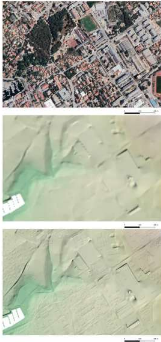
Slika 3.2.2 Satelitska snimka dijela naselja Zadar te usporedba digitalnog modela terena 5-m rezolucije (makro razina) i hibridnog model terena 1-m rezolucije (mezo razina).
