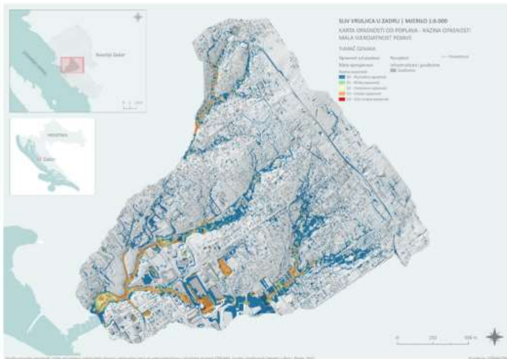
Slika 5.2.5 Karta opasnosti od poplava – razina opasnosti - za malu vjerojatnost u slivu Vruljica.
