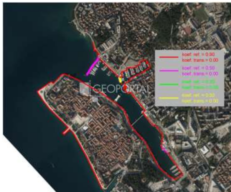
Slika 7.2.2. Koeficijenti refleksije i transmisije valova numeričkih simulacija
