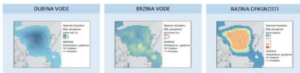
Slika 3.2.7 Primjer odabranih indikatora opasnosti od pluvijalnih poplava: dubina vode, brzina vode i razina opasnosti.
