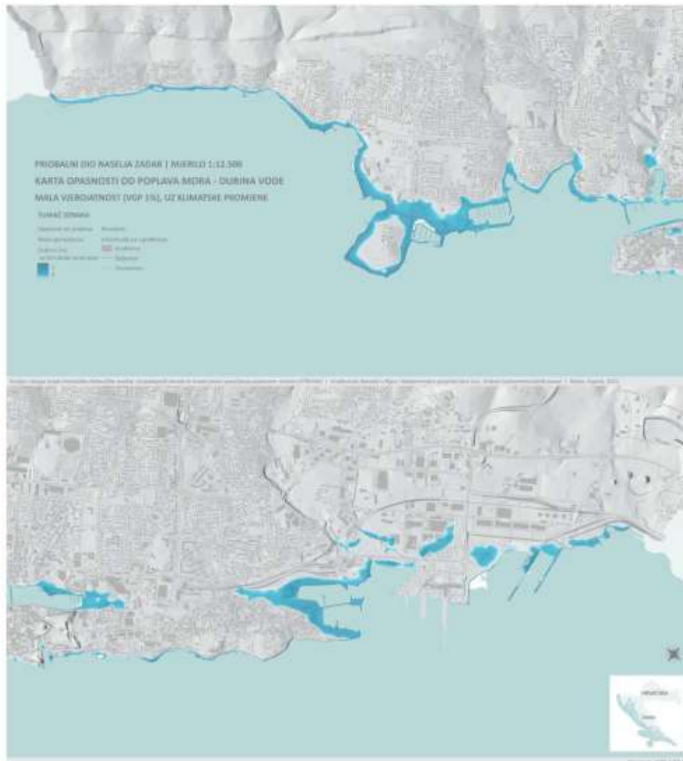
Slika 4.5.2. Karta opasnosti od poplava s mora za priobalni dio naselja Zadar – dubina vode za malu vjerojatnost pojavljivanja visokih razina mora uz klimatske promjene.
