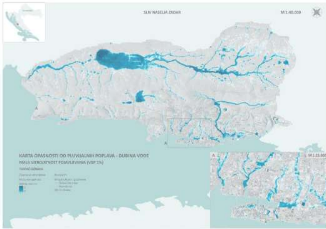
Slika 4.3.8 Karta opasnosti od poplava – dubina vode - za malu vjerojatnost na pilot području Zadar.
