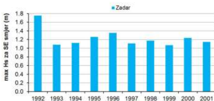
Slika 4.1.11. Maksimalne godišnje značajne valne visine iz modela valnog generiranja i valnih deformacija (područje Jadrana) za poziciju akvatorija grada Zadra tijekom razdoblja 1992.-2001.
