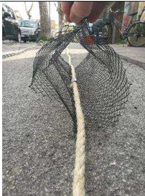
Figura 8. Collettore a rete (vista laterale)
