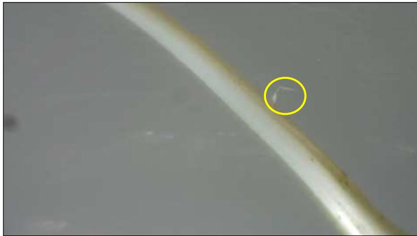
**Figura 6:** campione di Bio Net al microscopio, con evidenziati segni di degrado
