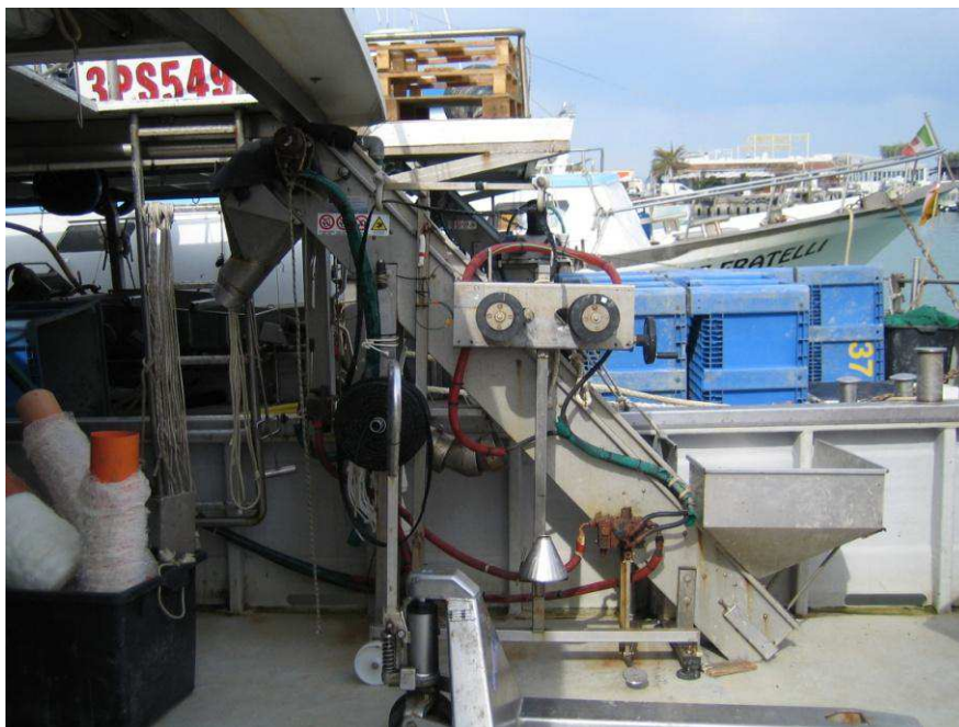
Foto 2 – Incalzatrice a bordo di una imbarcazione impiegata per la mitilicoltura.
