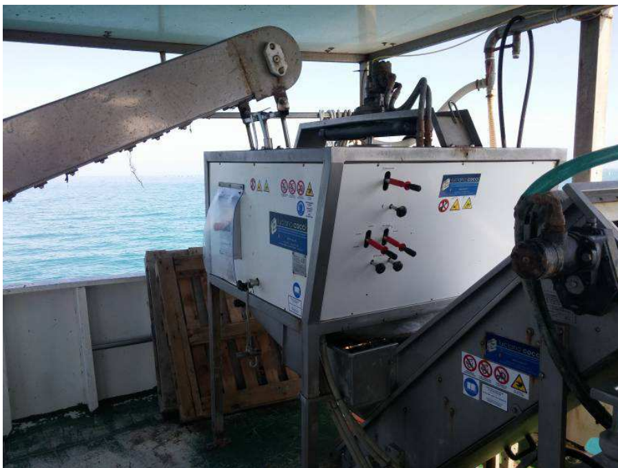
Foto 1 – Sgranatrice a bordo di una imbarcazione impiegata per la mitilicoltura
